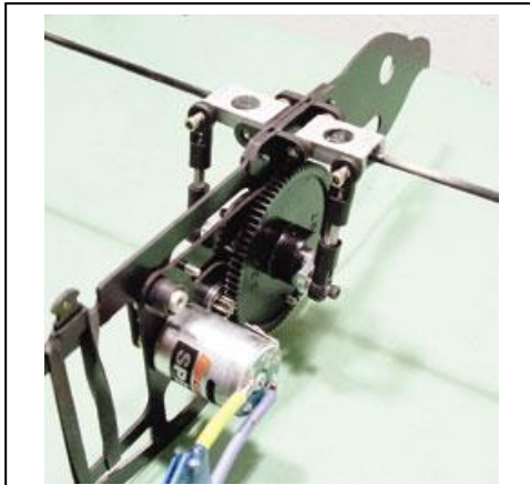
Bild 6: Getriebe des zeitweise kommerziell verfügbaren Fliegers Kestrel. Quelle: www.randrmodelaircraft.com
